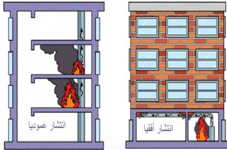
شكل (١): يمكن أن ينتشر الحريق أفقياً وعمودياً بهذه الطريقة كما هو في الشكل التوضيحي.
